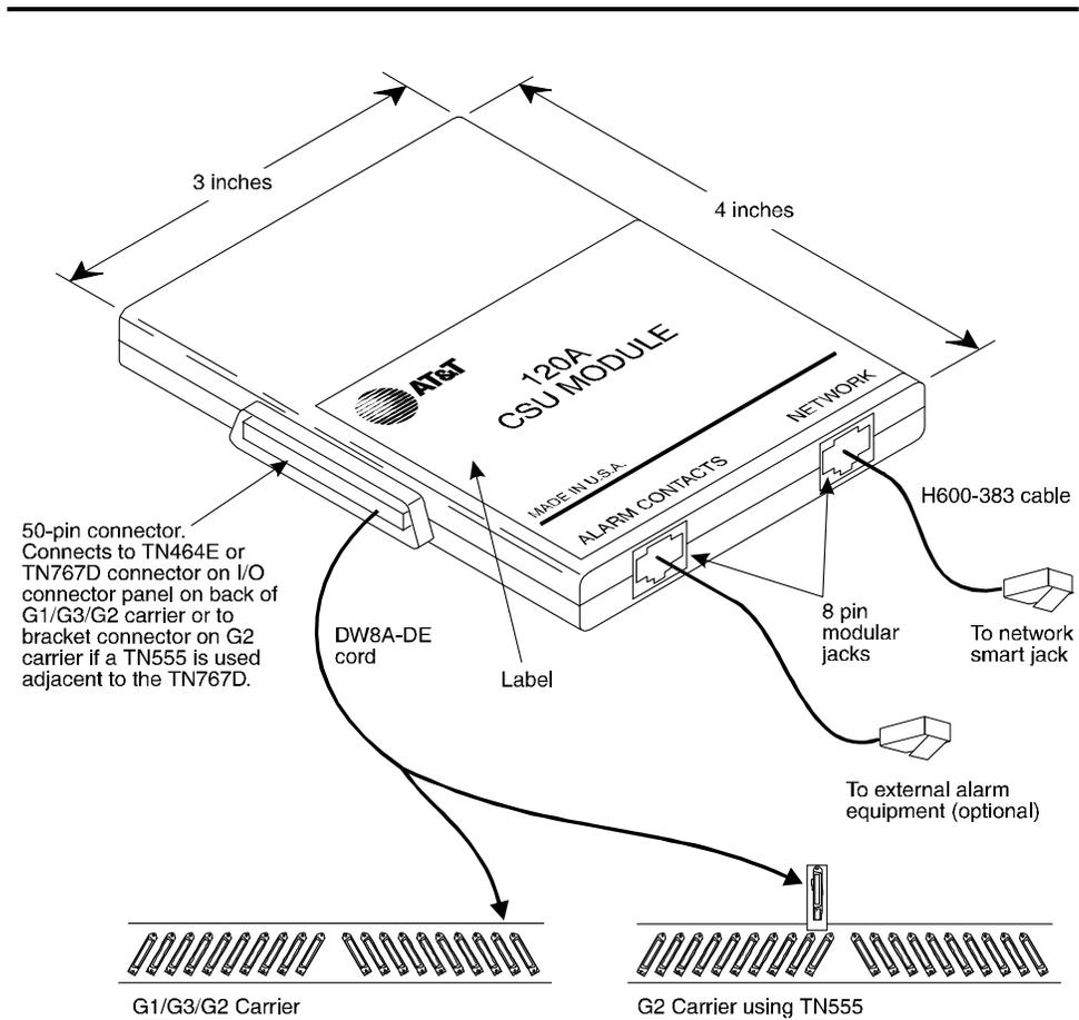
Figure 2. 120A CSU Module Installation
